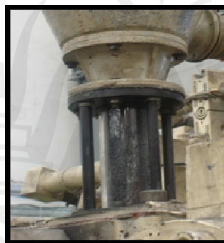
ภาพประกอบ 34 การป้อนพลาสติกเข้าเกลียวหนอนก่อนทำการหลอมใหม่ ที่มา : บริษัท 687 พลาสติก แอนด์ โมลด์ จำกัด. 2555.
