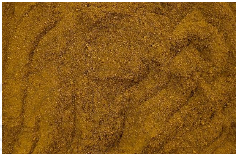
ภาพประกอบ 4.2 กากสมุนไพรที่ผ่านการบด อบแห้งและคัดแยกขนาดอนุภาคด้วยตะแกรง Mesh No.12
