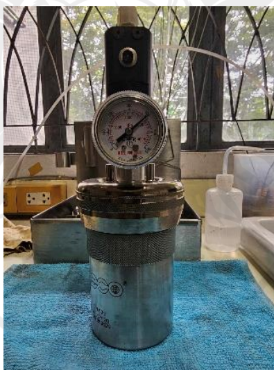
ภาพประกอบ 3.9 การบรรจุก้ำชออกซิเจนลงในภาชนะปิดสำหรับทดสอบ
