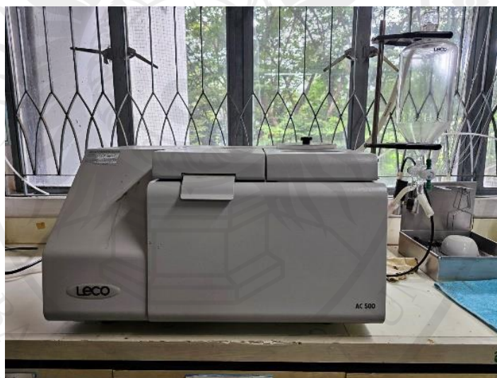
ภาพประกอบ 3.7 เครื่องวิเคราะห์ค่าความร้อน Bomb calorimeter
