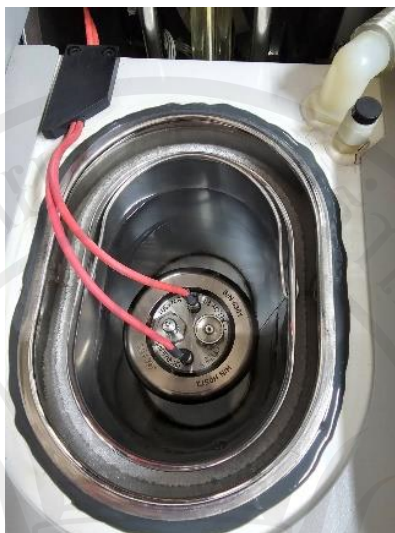
ภาพประกอบ 3.10 ภาพขณะทดสอบที่บรรจุน้ำขนาด 2 ลิตร ในเครื่องบอมบ์แคลอรีมิเตอร์
