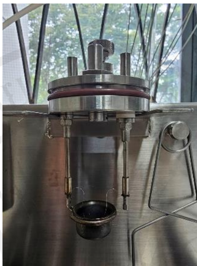
ภาพประกอบ 3.8 ถ้วยบรรจุสารตัวอย่างและชุดทดสอบหาค่าปริมาณความร้อน
