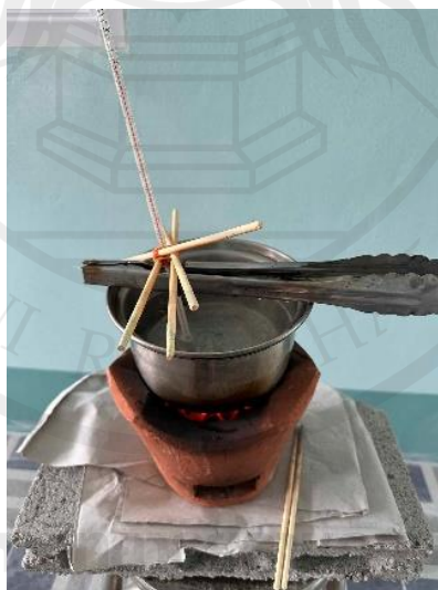
ภาพประกอบ 3.11 การทดสอบประสิทธิภาพการใ้งานของเชื้อเพลิง โดยการทดลองต้มน้ำเดือด
