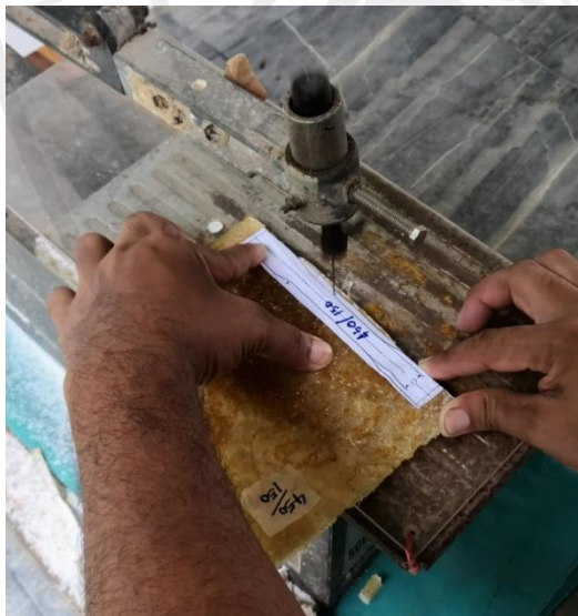
ภาพประกอบ 3.11 การตัดชิ้นงานไฟเบอร์กลาสตามมาตรฐาน ASTM D638
