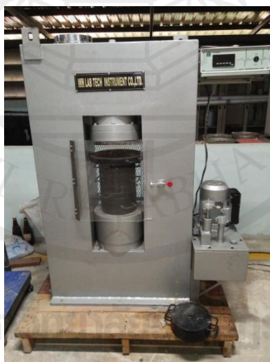
ภาพประกอบ 17 เครื่องกดทดสอบกำลังอัด
