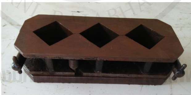
ภาพประกอบ 20 แบบหล่อตัวอย่างทรงลูกบาศก์ขนาด กว้าง 50 มิลลิเมตร ยาว 50 มิลลิเมตร สูง 50 มิลลิเมตร
