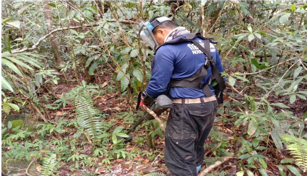
ภาพที่ 4.9 การใช้คนประกอบเครื่องตรวจจับสัญญาณโลหะในการค้นหาทุ่นระเบิดในพื้นที่ตำบลแหลมกลัด อำเภอเมืองตราด จังหวัดตราด ที่มา : (ถ่ายเองโดยผู้วิจัย, 2565)
