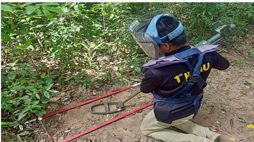
ภาพที่ 6.13 เจ้าหน้าที่ตรวจค้นหาทุ่นระเบิดโดยใช้เครื่องตรวจสัญญาณโลหะ ที่มา : (หน่วยปฏิบัติการทุ่นระเบิดด้านมนุษยธรรมที่ 1, 2564)
