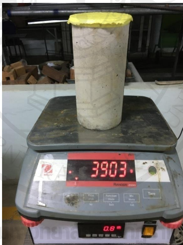
ภาพประกอบ จ.2 การหาน้ำหนักตัวอย่างคอนกรีต
