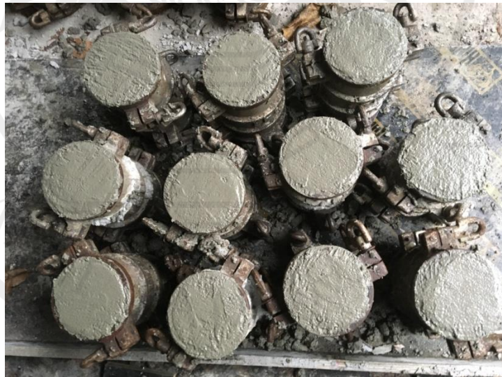
ภาพประกอบ 3.3 คอนกรีตที่เข้าแบบเรียบร้อยแล้ว
