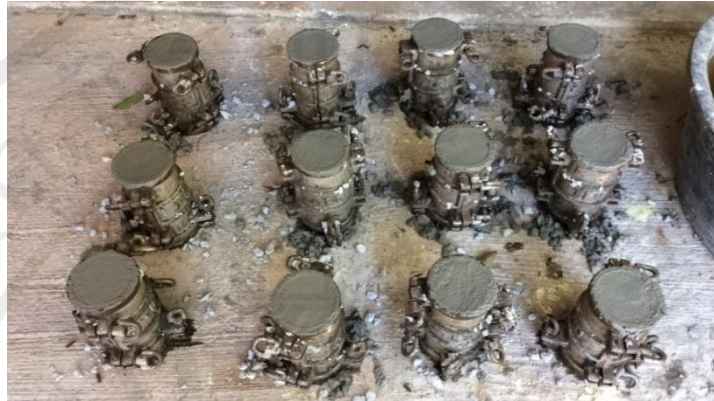
ภาพประกอบ จ.3 ตัวอย่างคอนกรีตภายหลังการเข้าแบบ
