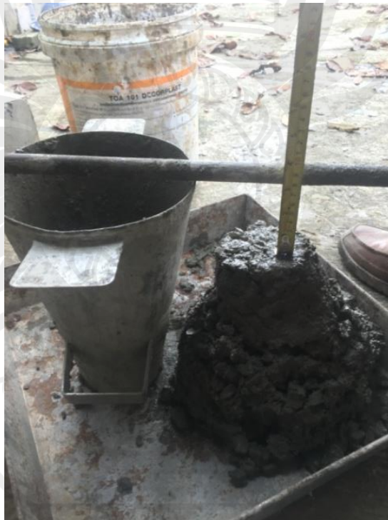
ภาพประกอบ 3.1 การวัดระยะยุบตัวของคอนกรีต
