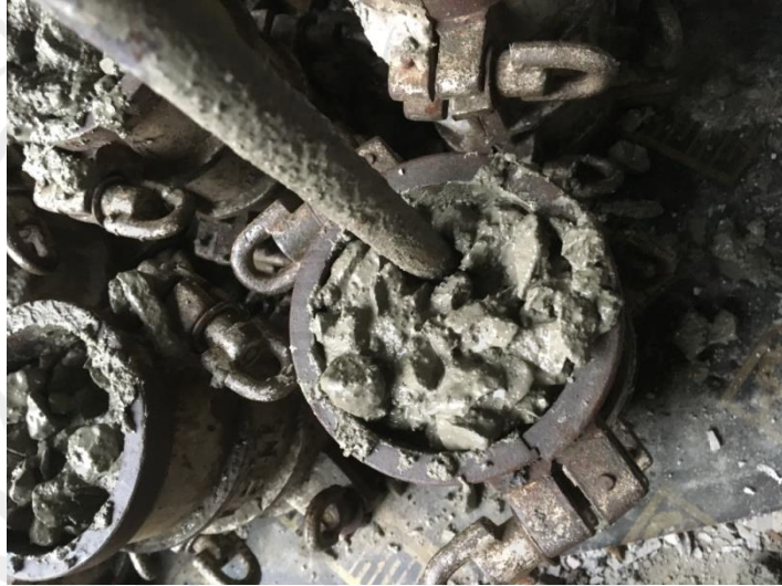
ภาพประกอบ 3.2 วิธีการเข้าแบบคอนกรีตสำหรับการทดสอบกำลังอัด
