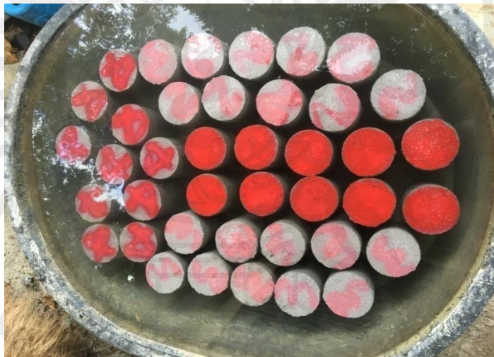
ภาพประกอบ จ.4 การบ่มตัวอย่างคอนกรีต
