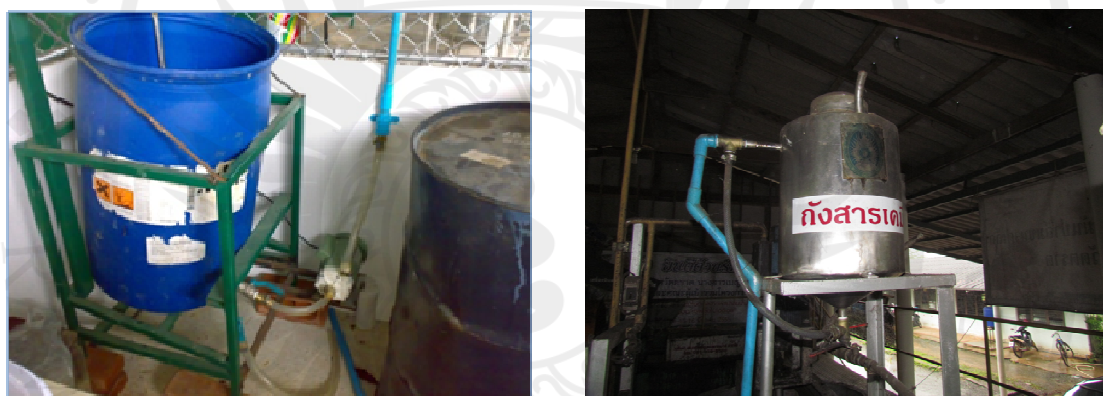
ภาพประกอบ 30 ระบบปั๊มเคมีขึ้นสู่ถังพักก่อนทำปฏิกิริยาไบโอดีเซล
