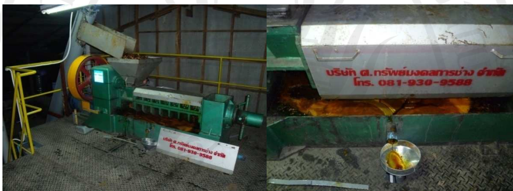
ภาพประกอบ 73 ผลปาล์มที่ผ่านกระบวนการทอดเข้าสู่เครื่องบีบสกัดด้วยระบบท่อสกรูลำเลียง
