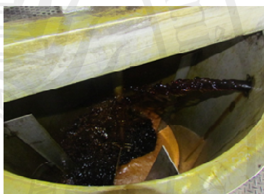
ภาพประกอบ 24 น้ำมันปาล์มดิบภายหลังการกรองแยกกากสลัดจ์ ถูกสูบขึ้นสู่อังคิคม
