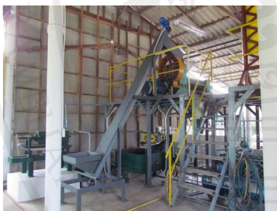
ภาพประกอบ 19 ท่อส่งลำเลียงผลปาล์มทอดสุกขึ้นสู่เครื่องหีบสกัดน้ำมันปาล์มดิบ
