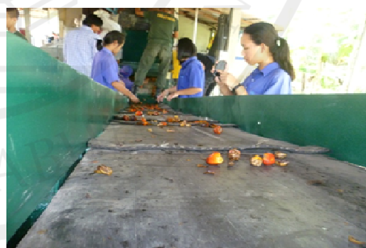
ภาพประกอบ 16 ทดลองตีแยกผลปาล์มและคัดกากข้อปาล์มขนาดใหญ่บนสายพานลำเลียง
