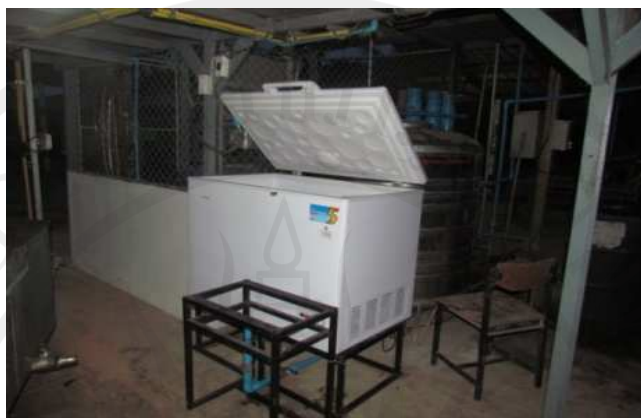
ภาพประกอบ 33 เครื่องทำความเย็น เพื่อลดอุณหภูมิไบโอดีเซลเป็น 10 องศาเซลเซียส
