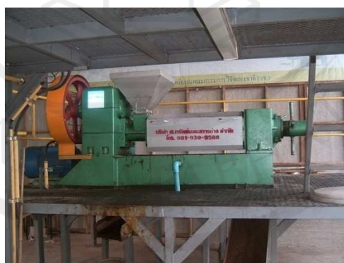
ภาพประกอบ 54 เครื่องหีบสกัดน้ำมันปาล์มดิบ
