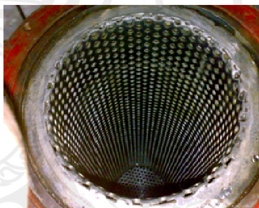
ภาพประกอบ 34 ผ้ากรองดักแยกไขไบโอดีเซลความละเอียด 1 ไมครอน และกระบอกอัดความดัน
