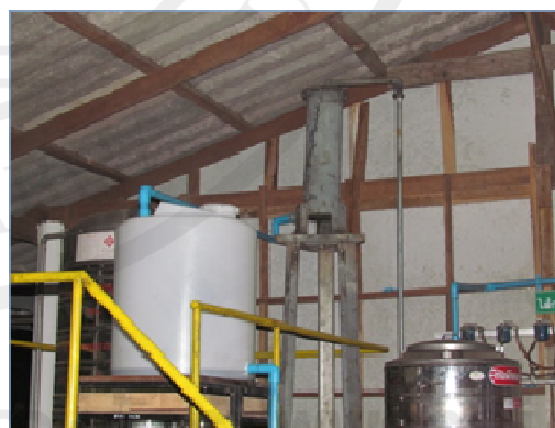
ภาพประกอบ 35 ระบบปั๊มส่งน้ำมันสู่ระบบกรองดักแยกไขไบโอดีเซล และระบบกรองดักแยก ฯ
