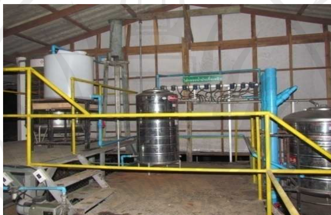
ภาพประกอบ 31 ถังสแตนเลสไหลเวียนระบบกรองเกลือ
