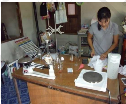
ภาพประกอบ 80 การตรวจหาค่าร้อยละของกรดไขมันอิสระจากน้ำมันปาล์มดิบภายหลังทำปฏิกิริยา
