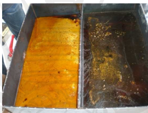
ภาพประกอบ 62 ถังดักแยกน้ำมันและน้ำ
