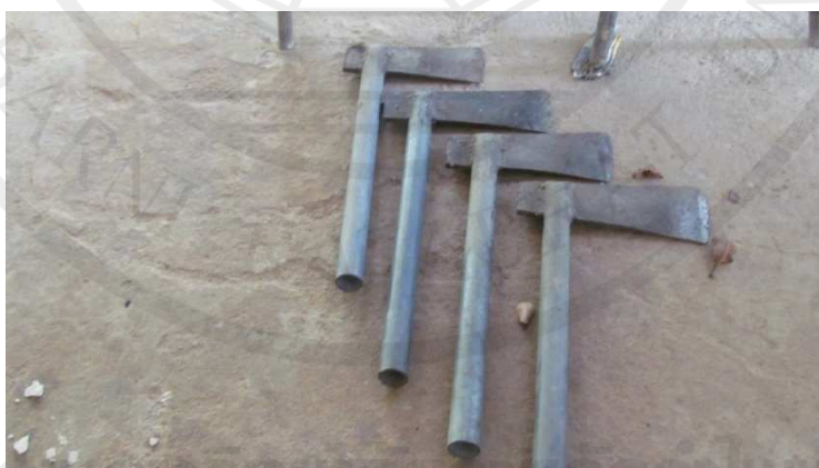
ภาพประกอบ 12 มีดสับปาล์มทำจากโลหะ
