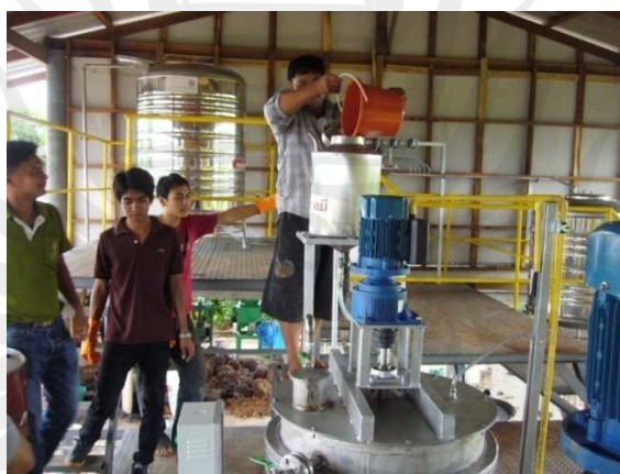
ภาพประกอบ 61 การเทสารเคมีลงในถังเคมีก่อนทำปฏิกิริยา
