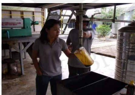
ภาพประกอบ 59 ถ่ายยางเหนียวและตะกอนปนเปื้อน
