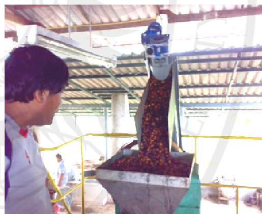
ภาพประกอบ 19 ท่อส่งลำเลียงผลปาล์มทอดสุกขึ้นสู่เครื่องหีบสกัดน้ำมันปาล์มดิบ
