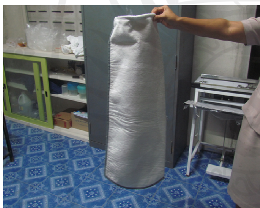
ภาพประกอบ 34 ผ้ากรองดักแยกไขไบโอดีเซลความละเอียด 1 ไมครอน และกระบอกอัดความดัน
