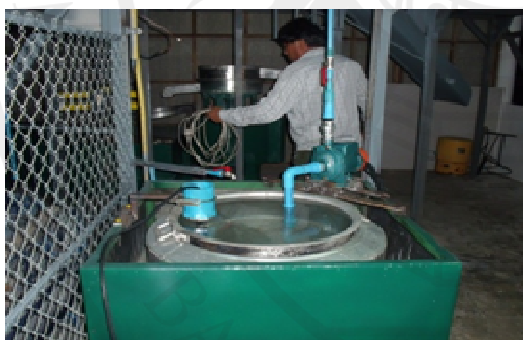
ภาพประกอบ 28 ระบบทำความร้อนและปั้มน้ำในกระบวนการล้างยางเหนียว และล้างไบโอดีเซล
