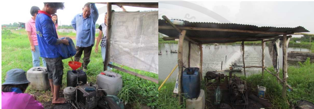
ภาพประกอบ 41 ทดลองใช้ไบโอดีเซล B100 กับเครื่องยนต์ดีเซลสำหรับดินำในนาุ้ง
