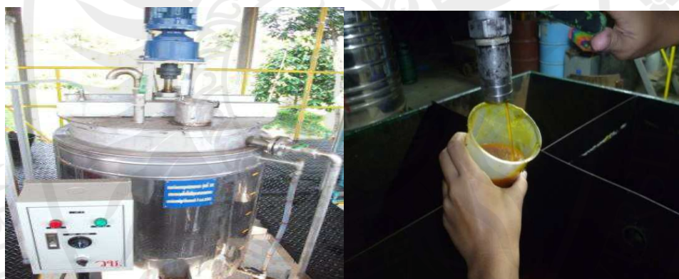
ภาพประกอบ 79 ปฏิกิริยาลดกรดไขมันอิสระในน้ำมันปาล์มดิบ
