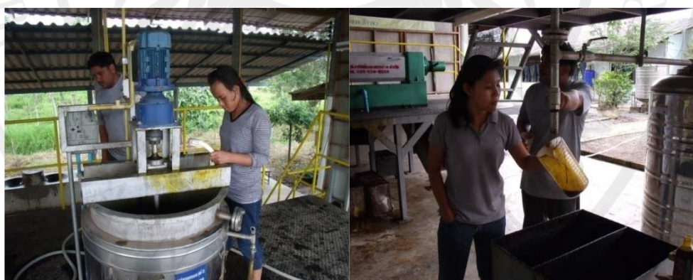
ภาพประกอบ 78 น้ำมันปาล์มดิบที่ผ่านกระบวนการดีกัม
