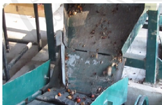
ภาพประกอบ 16 ทดลองตีแยกผลปาล์มและคัดกากข้อปาล์มขนาดใหญ่บนสายพานลำเลียง
