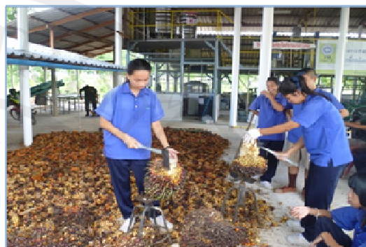
ภาพประกอบ 14 คัดแยกวัตถุดิบ สับแยกทะลายปาล์มออกเป็นข้อผลปาล์ม และฝังบนลานตาก
