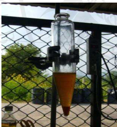
ภาพประกอบ 87 การทดสอบความบริสุทธิ์ของไบโอดีเซล
