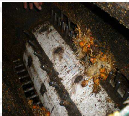
ภาพประกอบ 48 เส้นใยติดตามร่องฟันเครื่องตัด
